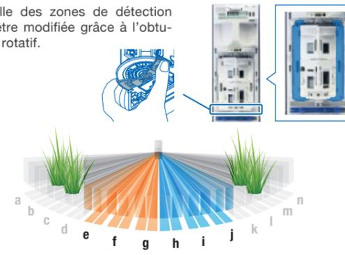
Lorsque la position de l'obturateur de masquage de zone sur la gauche est sur d et à droite sur k, les zones de détection a-d et k-n sont masquées.
